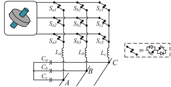
Fig. 23. Matrix AC-AC converter.
